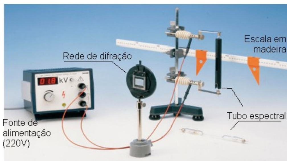
Figura 3. Arranjo do experimento para a análise dos espectros atômicos
